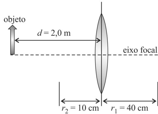
A figura precedente ilustra um objeto afastado a uma distância de uma lente delgada e esférica biconvexa de raios  $r_1$  e  $r_2$ . Considerando que os índices de refração do ar e do material da lente sejam iguais a 1,0 e 1,5, respectivamente, e que o valor da ampliação transversal seja igual ao sinal negativo da razão entre as distâncias da imagem e do objeto, respectivamente, julgue os próximos itens à luz da teoria para lentes delgadas.
