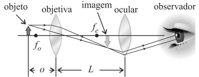
A figura precedente ilustra o funcionamento da objetiva e da ocular de um microscópio de luz, em que  $f_o$  e  $f_e$  são os pontos focais das lentes objetiva e ocular, respectivamente. Com base nessas informações e nas leis da ótica que descrevem o funcionamento de lentes, julgue os itens subsequentes.
