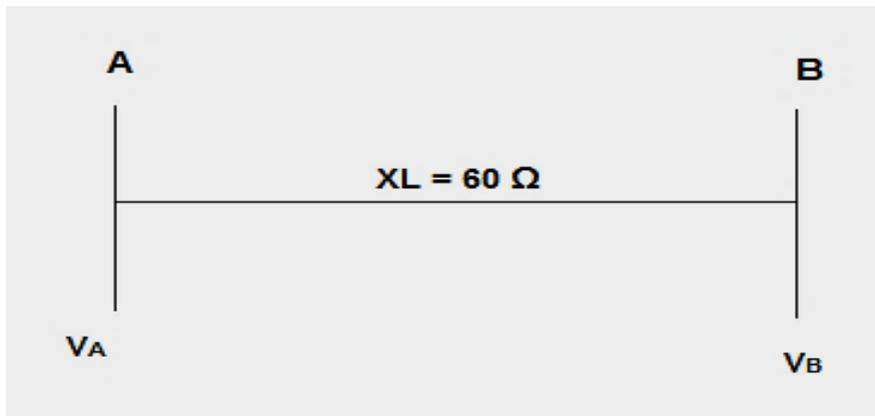
Qual deve ser o valor do ângulo de carga  $\delta$  que permite uma transferência de 110 MW da barra A para a barra B?
