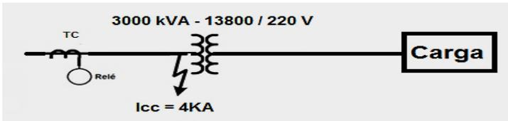
Considerando um fator de sobrecorrente igual a 20 e uma sobrecarga admissível para o transformador de 50%, a relação do TC e o ajuste do tape do relé serão:
