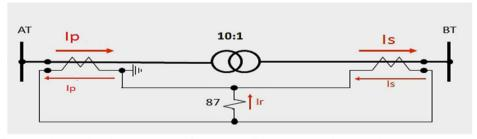
Em um determinado momento, foram medidos os seguintes valores de corrente primária dos lados de Alta Tensão (AT) e Baixa Tensão (BT) desse transformador: lp = 100 A; ls = 400 A. Sabendo que as relações dos TCs que alimentam a proteção são RTC (AT) = 200-5 A e RTC (BT) = 2000-5 A, é **CORRETO** afirmar:
