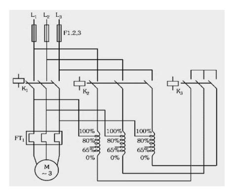
Para um comando em 220 V e TAP do autotransformador de compensação ajustado em 50%, os ajustes **mínimos** recomendados para os contatores K1, K2 e K3 do circuito de comando de partida são, **respectivamente**:
