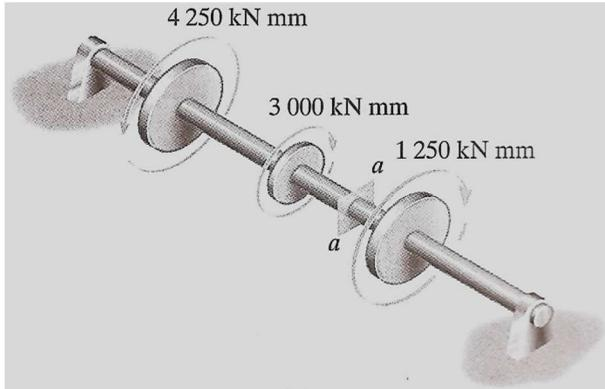
A tensão de cisalhamento no ponto mais externo da seção a-a do eixo é:
