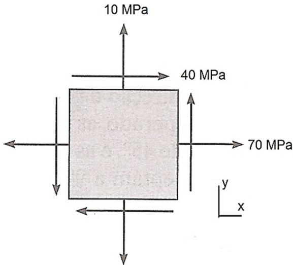
Para o estado plano de tensão no ponto apresentado na figura acima, as tensões normais principais e a tensão máxima de cisalhamento são, em MPa, **respectivamente**, iguais a:
