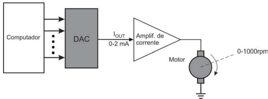
Com base na figura e nos conhecimentos de eletrônica digital, é correto afirmar que o número de *bits* que devem ser usados no DAC para que o computador produza uma velocidade no motor com uma variação máxima de 2 rpm da velocidade desejada, é:
