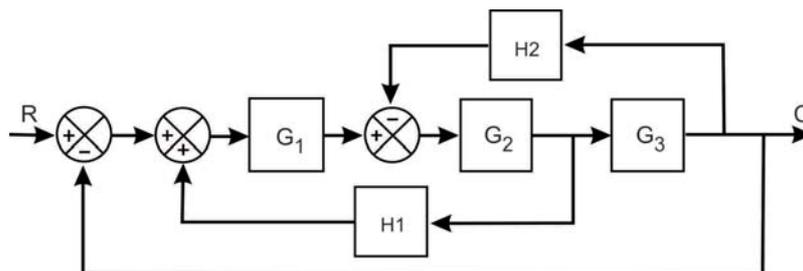
A figura representa um diagrama de blocos de um sistema com função de transferência C/R. Com base na figura, no enunciado e nos conhecimentos de engenharia de controle, é correto afirmar que a função de transferência de malha fechada C/R é dada por:
