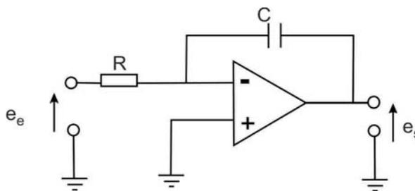
No circuito da figura temos  $R = 50 \text{ k}\Omega$  e  $C = 10 \text{ }\mu\text{F}$ . Na entrada ( $e_e$ ) do circuito aplica-se um degrau de tensão de amplitude igual a 2 V, durante 5 s. Suponha o capacitor C inicialmente descarregado e o amplificador operacional alimentado com  $\pm 15 \text{ V}$ .
