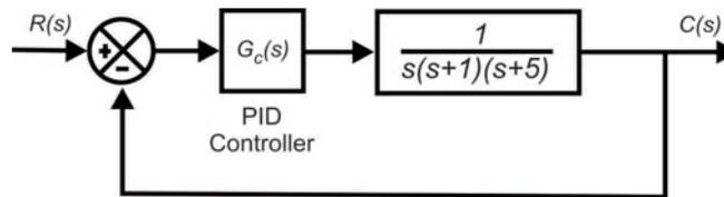
A figura ilustra uma planta, representada por sua função de transferência
