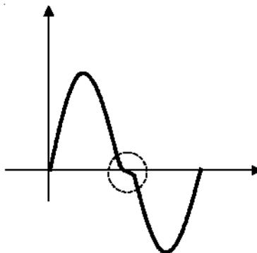
O gráfico da figura mostra um sinal senoidal que aparece, comumente, nos circuitos de saída de amplificadores de potência. O círculo pontilhado realça um efeito conhecido como distorção do tipo:
