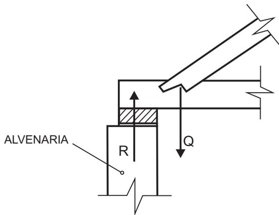
Sendo Q a componente vertical da resultante dos esforços provenientes da perna e da linha e R a reação da parede, o ideal é que a linha de ação de Q fique
