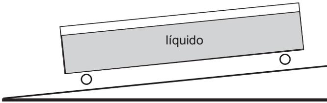
Um caminhão-tanque se move sobre uma pista ligeiramente inclinada em relação à direção horizontal. Em um determinado instante, constata-se que a superfície livre do líquido no interior do tanque está paralela à base do reservatório, conforme indicado na figura. Nesta condição, relativamente à pista, o veículo está
