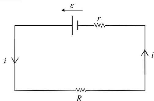
No circuito apresentado, a resistência interna da bateria é identificada por  $r$  e a resistência externa por  $R$ . A corrente que flui no circuito é de 2,0 A e a tensão na bateria, que tem força eletromotriz igual a 12 V, é igual a 8 V. Com relação a esse circuito, assinale a opção correta.
