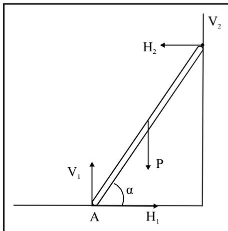
A figura acima representa uma escada de madeira apoiada em um plano horizontal e em uma parede vertical. As setas representam as forças que atuam na escada (as reações nos apoios e a força-peso  $P$ ).
