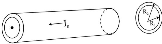
Considere uma casca cilíndrica condutora de raio interno  $R_1$  e raio externo  $R_2$ , muito longa, percorrida por uma corrente total igual a  $I_0$ , conforme mostrado na figura acima. Considerando esse modelo, assinale a opção correta, à luz da lei de Ampère.
