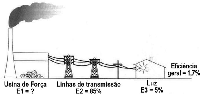
Sabendo-se que a eficiência na transmissão é  $E2 = 85\%$ , que a eficiência na conversão de energia elétrica em energia luminosa é  $E3 = 5\%$  e que a eficiência geral do processo, isto é, da conversão da energia química em luminosa é de  $1,7\%$ , a eficiência da usina de força  $E1$  é
