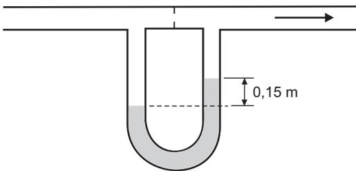
Um manômetro de água ( $\rho_A = 1000 \text{ Kg/m}^3$ ), posicionado verticalmente, é empregado em um medidor de vazão do tipo orifício. Para uma corrente de gasolina ( $\rho_G = 720 \text{ Kg/m}^3$ ), a leitura manométrica verificada é de 0,15 m. A leitura manométrica correspondente à mesma queda de pressão, caso se substitua a gasolina por óleo diesel ( $\rho_D = 850 \text{ Kg/m}^3$ ), em m, será:
