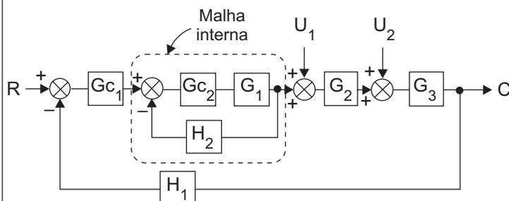
A função de transferência que representa a malha interna da figura acima é:
