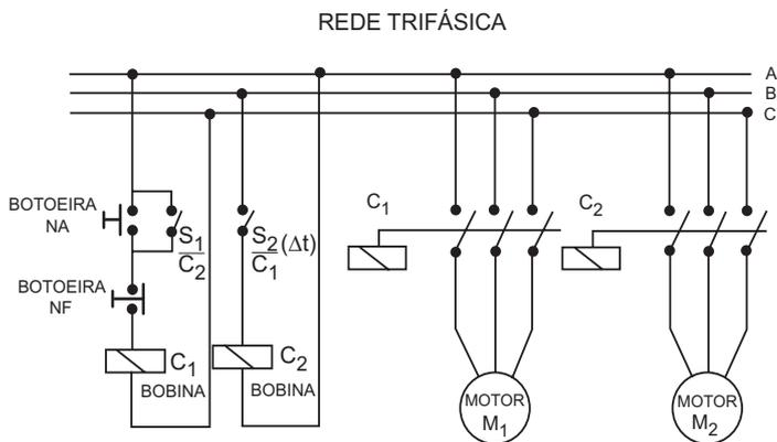
Um técnico projetou um sistema de controle para acionamento de motores, conforme o esquema simplificado acima. Sabe-se que a chave  $S_2$  possui um retardo de  $\Delta t$  segundos para mudar de estado. É correto afirmar que:
