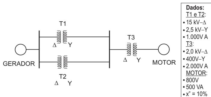
O diagrama unifilar simplificado acima apresenta um sistema composto de um gerador alimentando um motor por meio de três transformadores (T1, T2, e T3). A tensão e a potência de bases no setor em que se encontra o gerador são, respectivamente, iguais a 12 kV e 1.000 VA. Nessas condições, a reatância subtransitória ( $x''$ ) do motor, em p.u., é:
