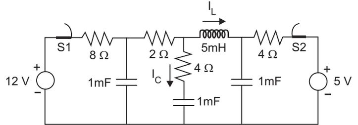
A figura acima apresenta um circuito elétrico, operando em regime permanente, com as chaves S1 e S2 fechadas.
