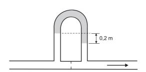
Uma corrente de solução salina ( $\psi$  = 1100Kg/m³) tem sua vazão medida por um medidor de orifício dotado de manômetro invertido, como se verifica no esquema acima. Qual a queda de pressão correspondente à leitura manométrica indicada, em Pa, sabendo-se que o fluido manométrico é um óleo com massa específica igual a 900Kg/m³ e que g = 10m/s²?
