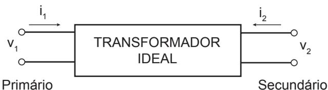
Se a corrente  $i_1$  do circuito primário é de 5 A, e a corrente  $i_2$  do circuito secundário é de 10 A, a tensão  $v_2$  no circuito secundário correspondente a uma tensão de 220 V no circuito primário, expressa em volts, será de
