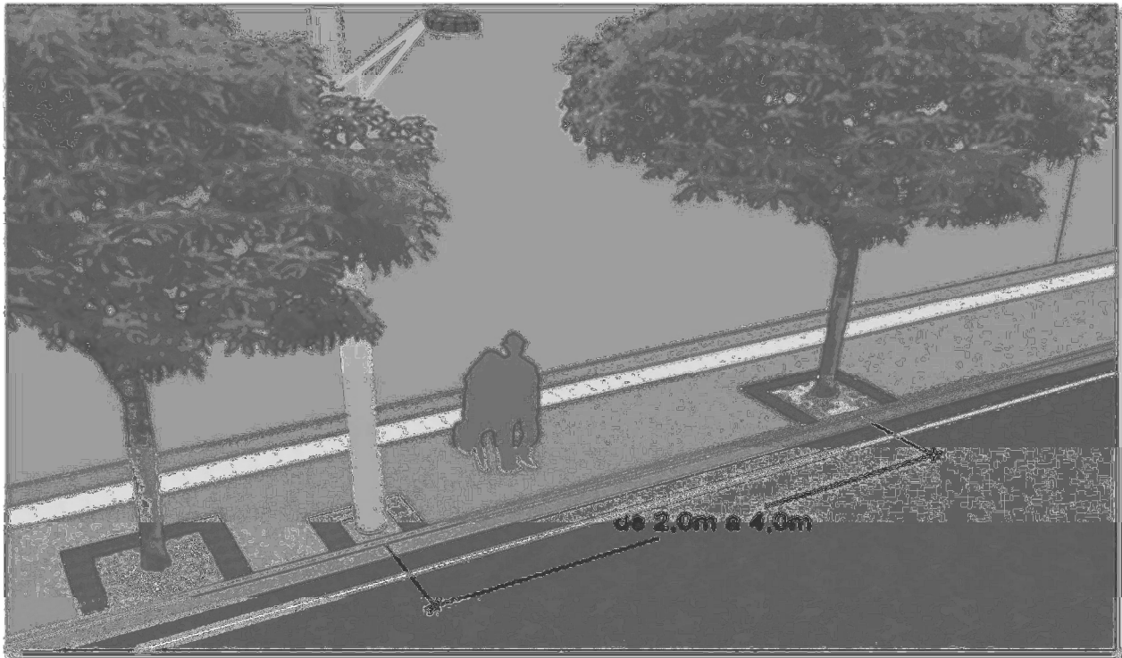
Figura 12a – Distância mínima do eixo do tronco de espécies de pequeno porte aos postes da rede aérea.
