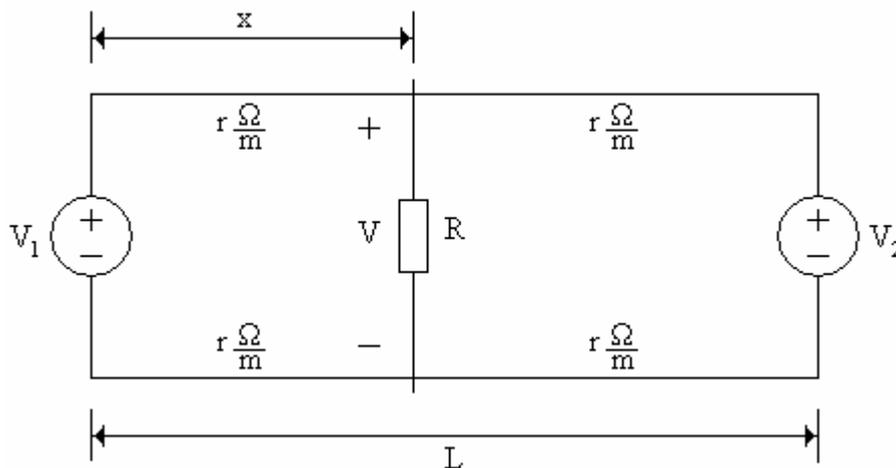
Seja  $x$  a distância entre a carga e a fonte  $V_1$  e  $L$  a distância entre as fontes, determine a tensão  $V$  :
