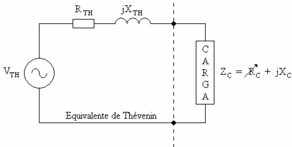
Considerando que a componente reativa da carga “ $X_C$ ” é fixa e que apenas a parte resistiva da carga “ $R_C$ ” pode ser ajustada, qual deve ser o valor de  $R_C$ , de modo que a transferência de potência para a carga seja máxima?
