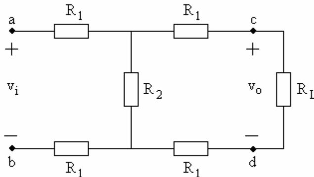
Ao projetar um atenuador, o projetista escolhe os valores de  $R_1$  e  $R_2$ , de modo que a relação  $v_o/v_i$  e a resistência vista pela fonte de entrada  $R_{ab}$  tenham valores especificados. Para  $R_{ab} = R_L$ , os valores de  $R_L$  e a relação  $v_o/v_i$  são:
