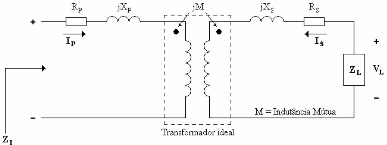
A impedância de entrada  $Z_i$  para esse transformador é:
