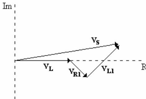
Colocando-se um capacitor em paralelo com os terminais da carga de forma que esta assuma uma característica puramente resistiva e mantendo a tensão terminal  $V_L$  constante, o novo diagrama fasorial do sistema é:
