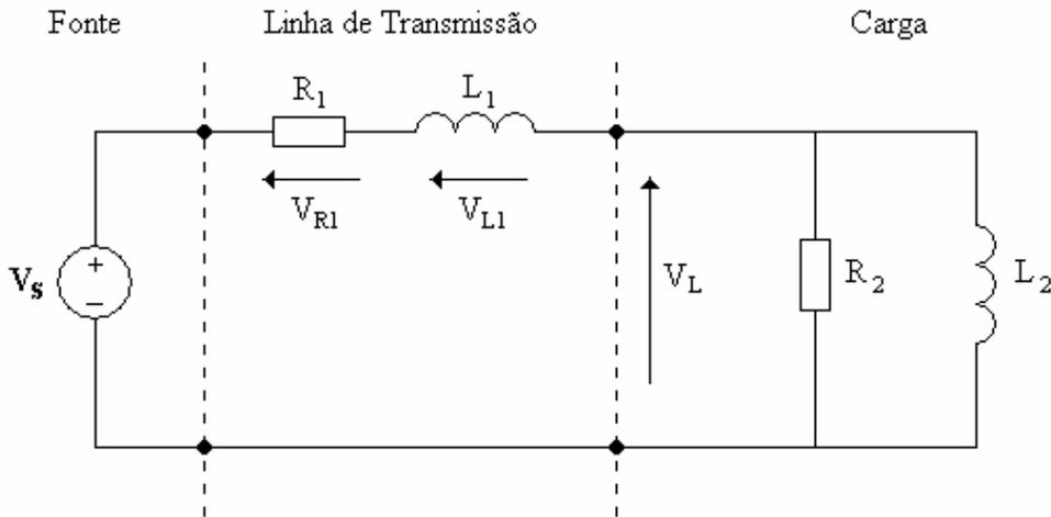
O circuito da figura acima modela um trecho de uma linha de transmissão alimentando uma carga indutiva, representada por  $R_2$  e  $L_2$ . Esta linha é suprida por uma fonte ajustável  $V_s$ . O diagrama fasorial das tensões do circuito, tendo  $V_L$  na referência, é dado abaixo.
