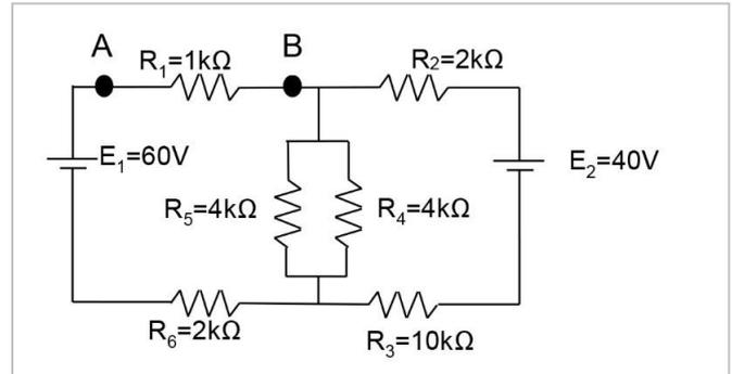
25 - Para o circuito ao lado, as correntes I<sub>1</sub> e I<sub>2</sub> e as tensões V<sub>ab</sub> e V<sub>bc</sub> são, respectivamente:
