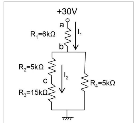
26 - Assinale a alternativa que determina o módulo da potência aparente total dissipada no circuito ao lado.
