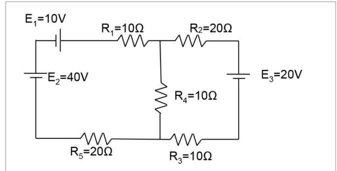
24 - Assinale a alternativa que determina o equivalente de Thévenin (resistência e tensão, respectivamente) entre os pontos A e B do circuito ao lado.
