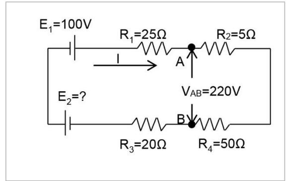
23 - Considerando o circuito ao lado, assinale a alternativa que indica a corrente que circula no resistor R<sub>4</sub> e o valor da queda de tensão sobre ele, respectivamente.
