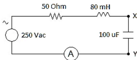
A partir do circuito equivalente resultante, o profissional deve calcular o valor total da corrente que passa pelo medidor, assim como o valor do módulo da tensão entre os terminais X e Y. Dessa forma, determine seus valores dissertando os procedimentos de cálculo.
