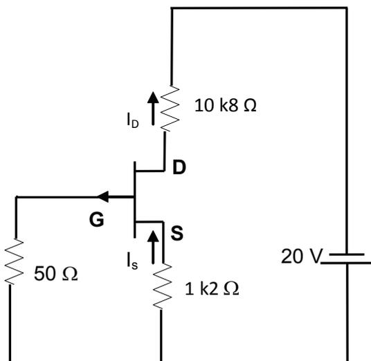
Sabendo-se que a tensão sobre o resistor de  $50 \Omega$  é de  $1,2 \text{ V}$  e que sobre o resistor  $10\text{k}\Omega$  é de  $8 \text{ V}$ , o valor de  $I_D$ , em  $\text{mA}$ , vale:
