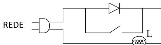
Admitindo-se que os componentes estejam adequados à tensão da rede, quando a chave for fechada, a lâmpada L terá seu brilho:
