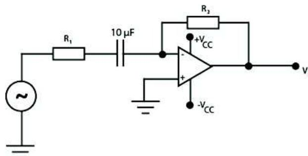
Considerando que o circuito tem um ganho de 10 e o sinal a ser diferenciado tem frequência de 2 kHz, nessas condições, os valores de R1 e R2, em  $\Omega$ , respectivamente, valem:
