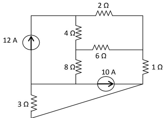
Pode-se dizer que a corrente que flui pelo resistor de  $2\Omega$ , em A, é de:
