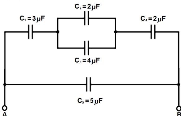
Determine a capacitância equivalente entre os terminais A e B.
