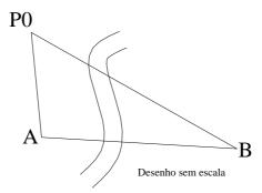
Uma empresa deseja construir uma ponte partindo-se de um ponto A até um ponto B, atravessando um córrego. Considerando a distância horizontal de um ponto P0 ao ponto A igual a 50 metros e do ponto P0 ao ponto B igual a 80 metros, com ângulo horário entre as visadas (P0-A para P0-B) de 60°00'00", a distância AB é igual a
