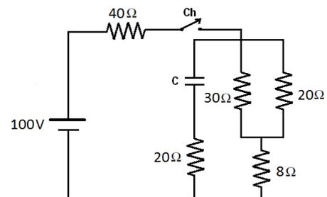
As correntes elétricas que fluem pelo resistor de 8 Ω, imediatamente após o fechamento da chave Ch e em regime permanente, são, respectivamente, iguais a
