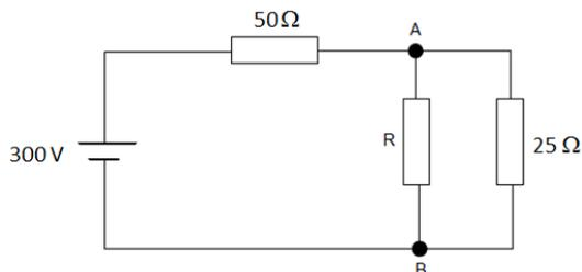
Um circuito equivalente entre os pontos A e B, que fornece a mesma tensão e a mesma corrente elétrica do circuito original ao resistor R, é formado por
