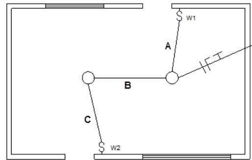
Considerando que os dois interruptores são do tipo *three-way* e que as luminárias são comandadas simultaneamente, assinale a opção que indica os condutores que devem passar, respectivamente, pelos trechos A, B e C.
