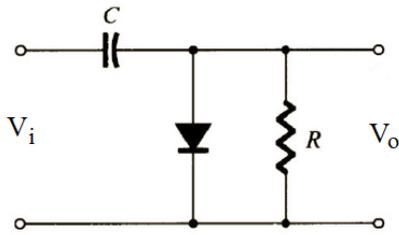
Na entrada desse circuito é aplicado um sinal de onda quadrada  $V_i$  de amplitude igual a  $V$ .
