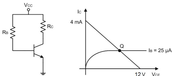
Sabendo que a tensão base-emissor do transistor é igual a 0,6 V, os valores dos resistores  $R_B$  e  $R_C$  para a polarização no ponto Q são, respectivamente,
