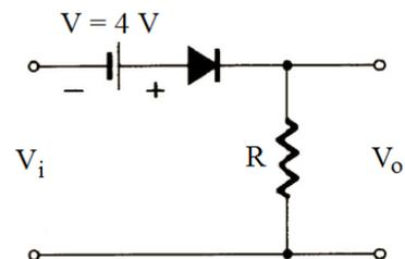
Na entrada desse circuito é aplicado um sinal senoidal  $V_i$  de amplitude igual a 10 V. A amplitude do sinal de saída  $V_o$  é de
