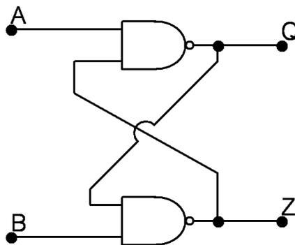
Sendo assim, ao se realizar uma transição do estado  $AB=10$  para o estado  $AB=00$ , o valor do estado de saída  $QZ$  é
