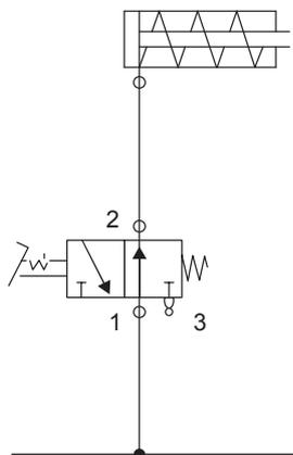
O acionamento do atuador pneumático simples é feito através de uma válvula de
