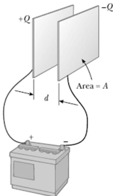
Duas placas paralelas separadas por uma distância  $d$  são ligadas aos polos de uma bateria, como representado na figura. Nesse caso, é correto afirmar que o campo elétrico na região interior das placas
