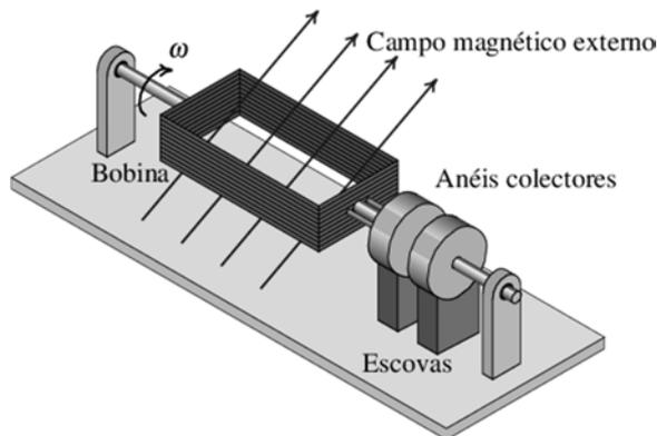
O circuito gerador de corrente elétrica alternada, representado na figura, consiste em dez voltas de um fio de cobre, formando uma bobina de área  $0,1 \text{ m}^2$ . O campo magnético externo equivale a  $0,5 \text{ T}$ , e a frequência de rotação é igual a  $\frac{60}{\pi} \text{ Hz}$ . Com base no exposto, assinale a alternativa que indica o valor da força eletromotriz máxima induzida.
