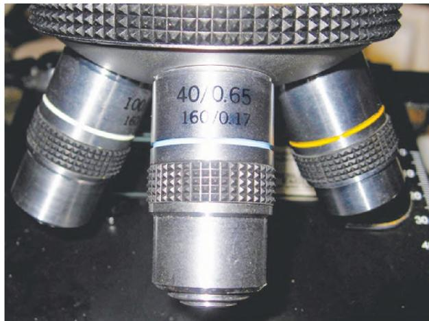
Figura 1. Lentes objetivas de um microscópio óptico
