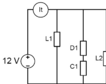
O circuito de emergência mostrado acima corresponde à instalação em uma sala de equipamentos elétricos. Nesse circuito, L1 é uma lâmpada incandescente de potência elétrica 36 W, D1 é um desumidificador de resistência  $1\Omega$ , C1 é um carregador de resistência  $3\Omega$  e L2 é uma lâmpada de resistência desconhecida.
