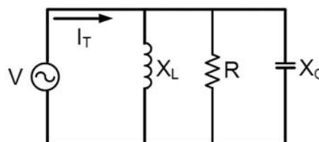
Para o circuito monofásico de corrente alternada mostrado acima, a reatância indutiva vale  $20 \Omega$ , a resistência vale  $40 \Omega$  e a reatância capacitiva vale  $60 \Omega$ .
