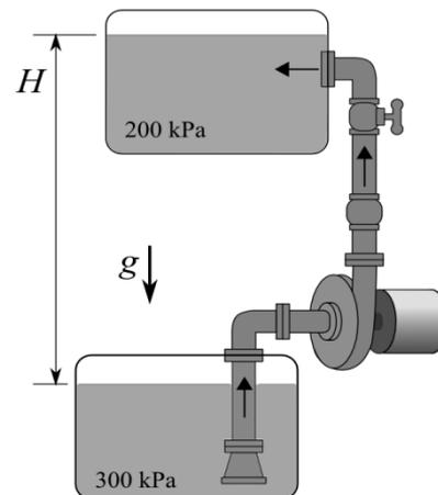
Assinale a alternativa cujo gráfico representa a curva característica do sistema hidráulico (vazão  $\times$  altura manométrica) em função das pressões manométricas dos reservatórios, da diferença de altura e da perda de carga.
