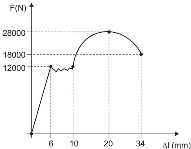
O gráfico encontra-se plotado com as forças e os alongamentos dos principais pontos de um ensaio de tração em um corpo de prova com 10mm de diâmetro e 100mm de comprimento inicial, que terminou com uma ruptura no meio do corpo, com um diâmetro médio de 6mm.
