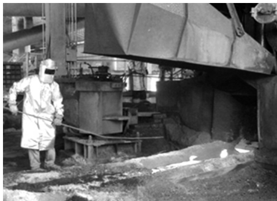
Figura do ambiente de trabalho. Trabalhador limpando o canal de vazamento do Ferrogusa.
