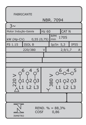
Se as bobinas desse motor forem ligadas a uma rede elétrica trifásica com tensão de linha de 380 V, a sua corrente nominal será de \_\_\_\_\_\_\_e sua corrente de partida de \_\_\_\_\_\_. Nesta mesma rede trifásica com tensão de linha de 380 V, o motor poderá ser ligado corretamente com as chaves de partida \_\_\_\_\_\_. Sendo um motor de 4 polos, seu escorregamento será de \_\_\_\_\_\_.
