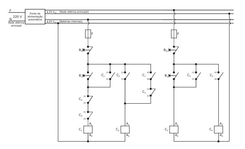
Considere a seguinte operação: durante uma falta de energia da rede principal, aciona-se manualmente o botão pulsante B2 e logo após aciona-se manualmente o botão pulsante B1. A(s) contatora(s) que se manterá(ão) energizada(s) após a operação descrita é (são)
