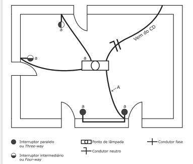
Considerando as informações do diagrama, os condutores que devem ser instalados no trecho de eletroduto indicado na figura por "A", para que a lâmpada seja comandada por 4 pontos independentes são
