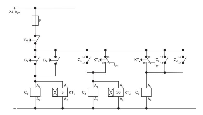
Considere que o circuito ainda está em fase de projeto e poderá ter falhas. Após 15 segundos do acionamento manual (durante 1 segundo) do botão pulsante B<sub>1</sub>, o(s) dispositivo(s) que se manterá(ão) energizado(s) é(são)
