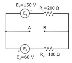
O circuito elétrico representado na figura é constituído por duas fontes de tensão contínua e dois resistores, todos componentes ideais. O valor, em módulo, da tensão entre os pontos A e B é de
