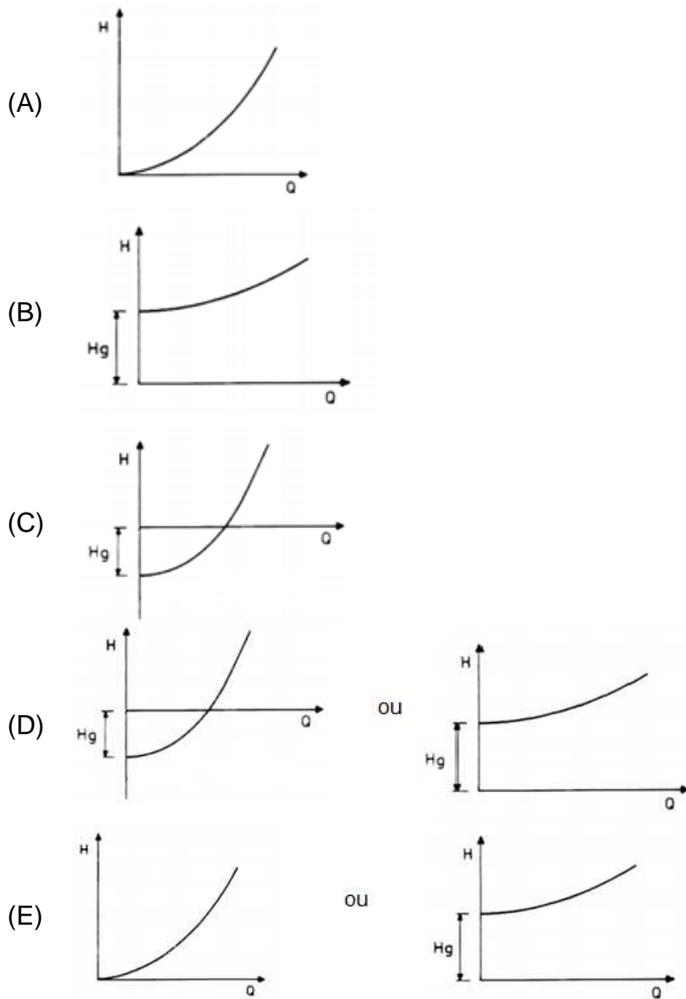
39. A curva característica de uma máquina hidráulica, bomba ou turbina é a representação gráfica ou em forma de tabela das funções que relacionam os diversos parâmetros em seu funcionamento. Dependendo da necessidade física ou da versatilidade desejada nas instalações elevatórias o projetista pode optar por conjunto de bombas em série ou em paralelo. Nas figuras abaixo em A tem-se a curva característica de uma bomba e nas situações B e C temos a associação de duas bombas A iguais.
