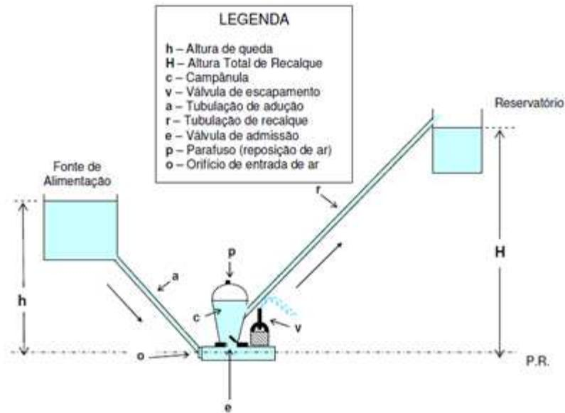
A equação que descreve a vazão recalcada  $q$ , é dada por:
