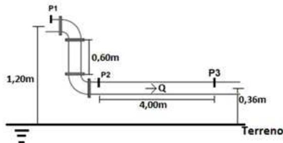
34. Assinale a sequência correta que apresenta a perda de carga total entre P1 e P3, a perda de carga total entre P1 e P2, a perda de carga distribuída entre P2 e P3 e a perda de carga localizada entre P1 e P2, devido às 2 (duas) curvas longas de  $90^\circ$ :
