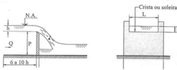
Um professor pediu a um técnico para ir a campo medir a vazão de uma seção de um córrego onde havia um vertedor desses instalado. Na seção instalada há uma régua bem posicionada para se visualizar o nível de água. O técnico com a equação de vazão do vertedor precisou identificar e medir alguns itens do vertedor para poder utilizar a equação. Os itens identificados na figura como h, P e L são respectivamente:
