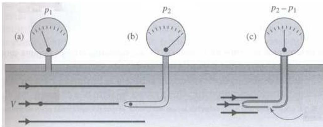
De acordo com as linhas de fluxo e escoamento do fluido, as pressões medidas nos medidores a, b e c são respectivamente:
