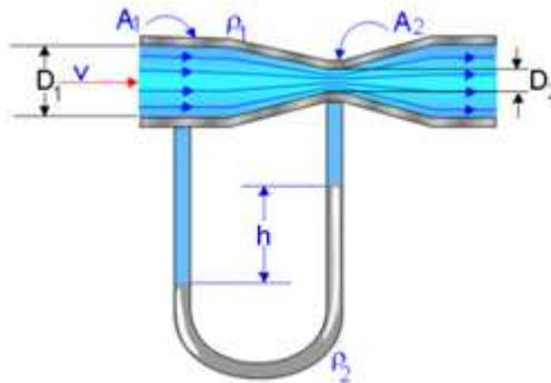
Explicando ao professor, um dos alunos relatou que este dispositivo é uma peça especial, colocada em linha na canalização para medir vazão, onde a orientação da peça deve ser sempre com a parte convergente no sentido do fluxo de fluido, seguido posteriormente de garganta ou estrangulamento e parte divergente porque o mesmo tem o propósito de acelerar o fluido e temporariamente baixar sua pressão estática, criando um diferencial de pressão.
