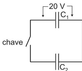
Em um circuito, dois capacitores estão ligados entre si como na Figura acima. O capacitor  $C_1$  está carregado, e a diferença de potencial elétrico entre suas placas é de 20 V. A chave é fechada, e aguarda-se até que o equilíbrio eletrostático seja atingido; a diferença de potencial entre as placas do capacitor  $C_1$  diminui para 12 V.
