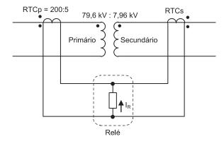
A relação de transformação do transformador de corrente conectado ao primário é RTCp = 200:5. Em condições normais de operação, a corrente I<sub>P</sub> do relé é nula.
