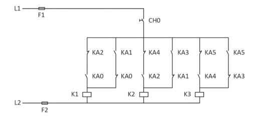
A Figura acima apresenta o circuito para acionamento de três contatoras principais (K1, K2 e K3) que controlam os processos de aquecimento e de resfriamento de caldeira em uma fábrica. Além dos fusíveis de proteção F1 e F2, o circuito ainda utiliza os contatos de 6 contatoras auxiliares (KA0, KA1, KA2, KA3, KA4 e KA5) que são acionadas em um circuito auxiliar independente.
