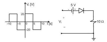
Aplicando-se na entrada V, a onda quadrada periódica mostrada na Figura, o valor da potência média, em W, dissipada na carga resistiva de 10  $\Omega$ , é
