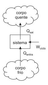
O coeficiente de desempenho ( $\gamma$ ) de um sistema que percorre um ciclo de bomba de calor, como o representado na Figura acima, em termos das energias  $Q_{\rm entra}$  e  $Q_{\rm sai}$ , é dado por
