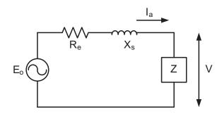
Após a análise da Figura, verifica-se que, com relação à corrente de armadura I<sub>a</sub> e à tensão nos terminais V, a reação da armadura tende a
