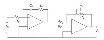
Esse circuito é constituído de dois amplificadores operacionais considerados ideais, sendo que esse tipo de configuração ilustrado é usado na implementação de compensadores avanço/atraso para controle de sistemas.
