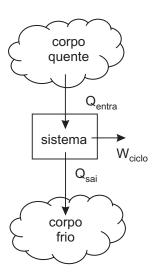
A eficiência térmica (η) de um sistema que percorre um ciclo de potência, como o representado na Figura acima, em termos das energias  $Q_{entra}$  e  $Q_{sai}$ , é dada por
