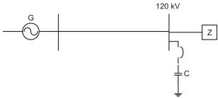
Na Figura acima, o gerador G alimenta uma carga pesada Z através de uma linha de transmissão. Um banco de capacitores conectado à barra de carga tem características nominais de 150 MVAR e 130 kV.
