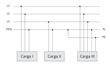
A Figura acima mostra uma instalação elétrica de baixa tensão com três cargas conectadas (I, II e III). As cargas I e II estão conectadas em uma parte da instalação onde os condutores de proteção e de neutro estão unificados em um condutor PEN; já a carga III está conectada na outra parte da instalação, onde os condutores de proteção e de neutro são distintos (PE e N). Considere que o condutor PEN está diretamente conectado ao aterramento da alimentação da instalação.
