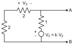
Para que a resistência equivalente entre os pontos A e B seja igual a 1 ohm, o valor da constante k é
