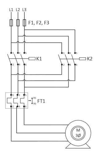
O acionamento do motor pode ser feito pela contatora K1 ou pela contatora K2, o que permite a operação do motor com
