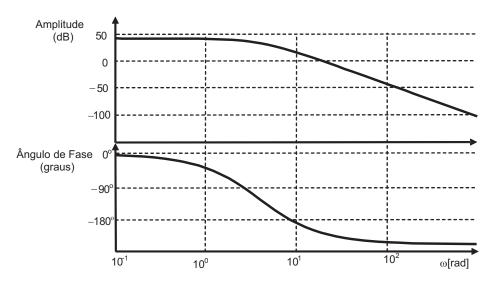
Com base nas curvas de amplitude e fase, constata-se que o sistema em malha fechada será
