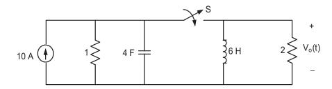
$V_o(t)$  e  $\frac{dV_o(t)}{dt}$  em t = 0<sup>(+)</sup> (imediatamente após o fechamento da chave) são iguais, respectivamente, em volts e
