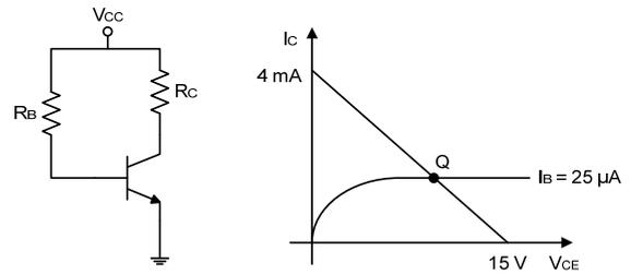
Sabendo que a tensão base-emissor do transistor é igual a 0,7 V, determine os valores dos resistores  $R_B$  e  $R_C$ , ambas em  $k\Omega$ , para a polarização no ponto Q.
