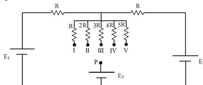
Para que a corrente elétrica no ramo central do circuito seja igual a zero, o ponto P deve estar conectado ao ponto
