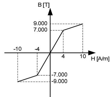
Sabendo que a permeabilidade magnética do vácuo é  $4\pi \times 10^{-7}$  H/m, a permeabilidade relativa do material na região saturada da curva é:
