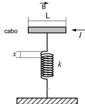
Em um dado ensaio, o condutor é percorrido por uma corrente  $I$ , cujo sentido é indicado na figura.
