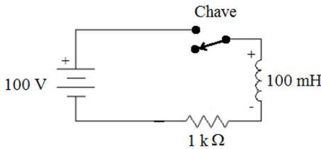
Para o circuito da figura acima, a corrente elétrica, após 1 segundo a chave ser ligada, é dada pela expressão:
