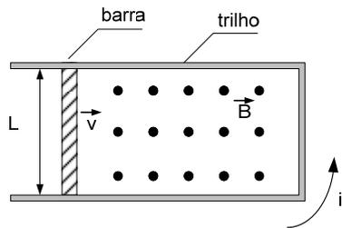
Tanto a barra quanto o trilho são feitos de material condutor. A barra move-se com velocidade constante  $v$  sobre o trilho em uma região que possui uma densidade magnética constante (apontando para fora do plano da página). O trilho é um condutor ideal e a barra possui resistência  $R$ .
