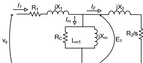
Sabendo-se que o motor opera com um escorregamento de 5% e o módulo da corrente  $I_2$  é de 10 A, assinale a opção que indica a potência total dissipada nos enrolamentos do rotor, em W.
