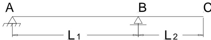
Assinale a viga conjugada para obter a flecha e a rotação da linha elástica no ponto C com o emprego da Analogia de Mohr.
