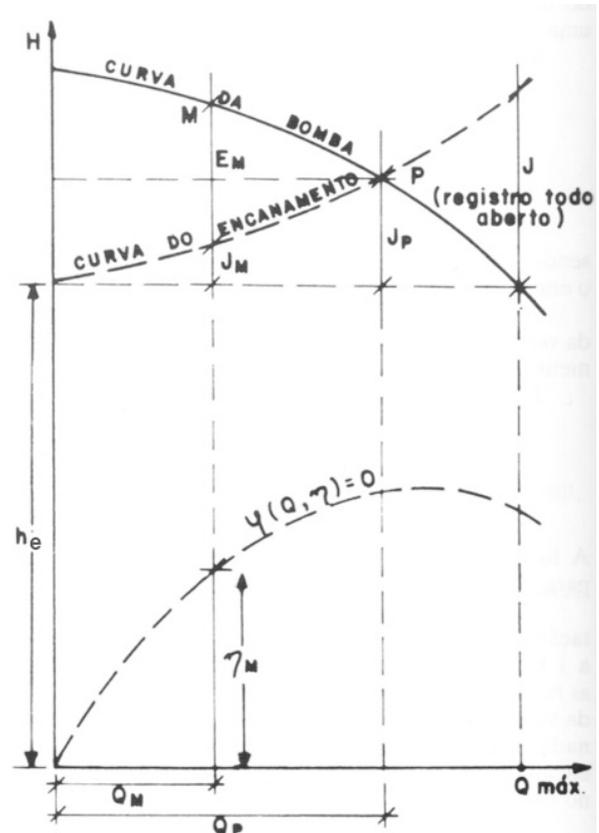
Sabendo que  $h_e$  é a altura estática de desnível e que para um ponto  $i$  genérico:  $J_i$  é a perda de carga,  $\eta_i$  é o rendimento e  $Q_i$  é a vazão, analise as afirmativas a seguir.
