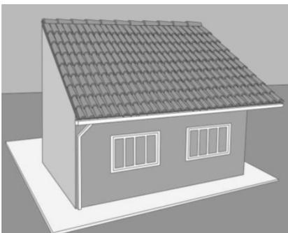
Se a precipitação crítica de projeto é de  $120\text{ mm/h}$ , determine a vazão de dimensionamento da calha, segundo a NBR nº 10.844/89.
