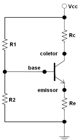
A tensão  $V_{cc}$  desse circuito é de 12 V e a corrente no emissor é igual a 4mA. Os resistores  $R_e$  e  $R_c$  são iguais, respectivamente, a  $200\ \Omega$  e a  $1200\ \Omega$ . As quedas de tensão, em volts, nos resistores  $R_e$  e  $R_c$  são, respectivamente, iguais a
