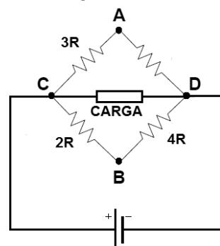
O valor do resistor conectado entre os pontos A e D, a fim de que a potência na carga elétrica seja igual a zero, deve ser igual a
