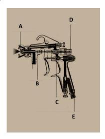
O parafuso de ajuste da agulha de fluido, pelo qual se aumenta ou diminuir o volume de saída da tinta, é indicado pela letra:
