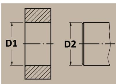
As peças têm diâmetro nominal igual a 5,000mm, a margem adotada é de 0,020mm e a tolerância para o furo vale 0,016mm, enquanto a tolerância para o eixo é de 0,010mm. Sabendo que as peças foram ajustadas com folga empregando o sistema furo-base, o limite superior da medida D1 e o limite inferior da medida D2 valem, respectivamente:
