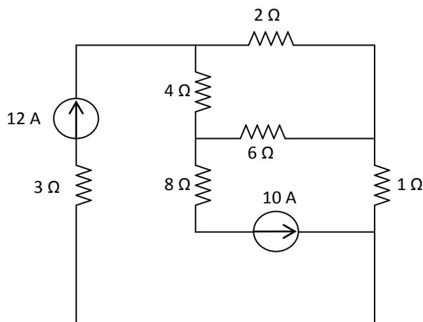
O resistor de 2 Ω é percorrido por uma corrente de:
