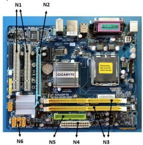
Uma placa de memória DDR3 e os cabos de dados de um disco rígido SATA devem ser conectados nos componentes identificados, respectivamente, por:
