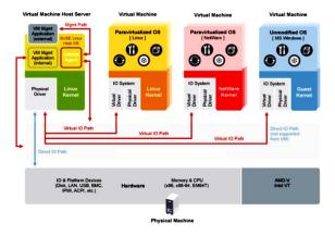
Um dos componentes básicos do ambiente de virtualização *Xen-based* é algumas vezes chamado de monitor de máquina virtual, um programa *open source* que coordena a interação e baixo nível entre as máquinas virtuais e o hardware. Esse componente é denominado:
