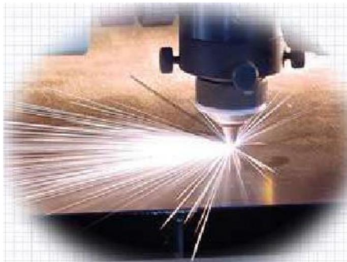
A operação de corte a laser pode ser assistida por um gás (ar, O<sub>2</sub> ou Ar).
