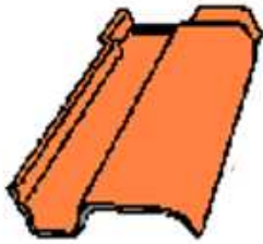
(1) Telha plana conjugada (capa e canal).
