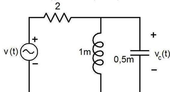
Com o circuito operando em regime permanente, a tensão  $v_c(t)$  sobre o capacitor, em Volts, é
