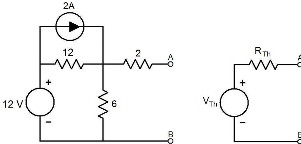
Os valores de  $R_{Th}$ , em ohms, e de  $V_{Th}$ , em volts, são respectivamente:
