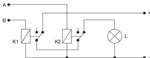
Para acionamento da lâmpada, o circuito de relés executa a função lógica
