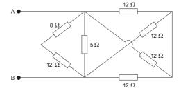
A resistência equivalente entre os pontos A e B é igual a
