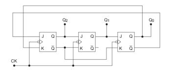
Após dois pulsos de clock, as saídas  $Q_0$ ,  $Q_1$  e  $Q_2$  indicam, respectivamente, os estados lógicos
