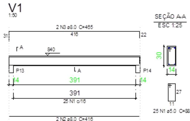
Sabendo-se que a barra de 8,0mm pesa 0,40 kg/m e a barra de 5,0mm pesa 0,16 kg/m, o consumo de aço, em quilos, para a montagem desta viga, considerando-se perdas, é:
