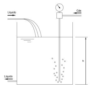
Como a indicação do manômetro corresponde à carga exercida pela coluna de líquido, a conversão da escala de pressão para a escala de altura, h, é função
